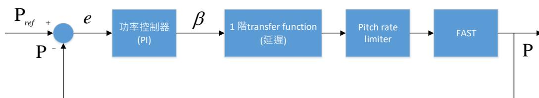
圖 5-8 變旋角控制系統方塊圖
