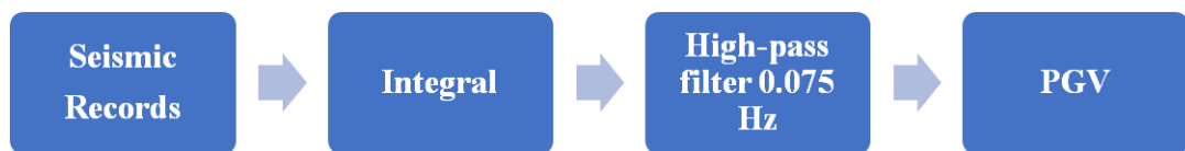
圖 2-2 PGV 的作業流程圖，將地震紀錄原始資料進行積分後，再使用 Butterworth 濾波器濾出 0.075Hz 訊號，找出各測站速度取絕對值後的最大值即為 PGV。
