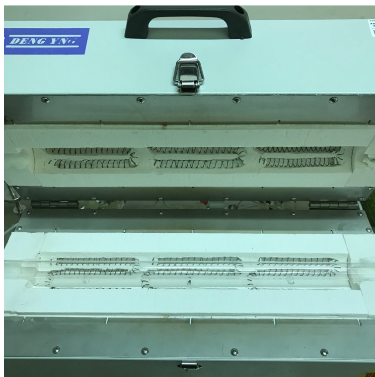
圖 4-6 化學氣相沈積系統－加熱爐內部構造
