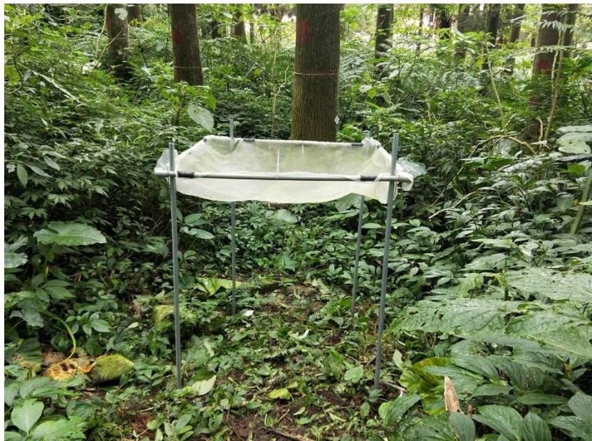
圖 4. 枯落物收集網 (Litter trap) 照片。照片為 CJ53 樣區中的枯落物收集網，收集網面積為 1 m × 1m，離地高 1 m，每個月收集一次網中所有枯落物，照片拍攝日期為 2017 年 11 月 3 日。
