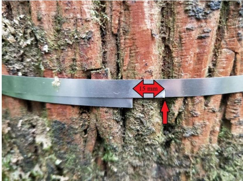
圖 3. 樹徑生長鐵環 (Dendrometer) 照片。右方箭頭顯示裝設初期鐵環終點的初始位置，平行箭頭顯示隨林木生長後，鐵環被拉長後的位置。照片拍攝日期為 2017 年 11 月 3 日，胸圍拉長距離約為 15 mm。
