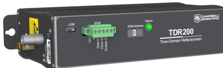
Fig. 3.1 時域反射儀(TDR) (圖片來源引用自 Campbell Scientific 公司網站)
