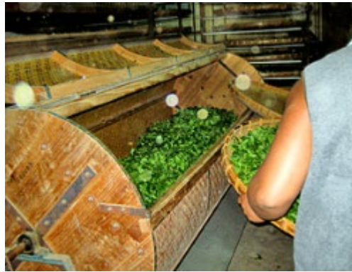
圖表 16 茶葉製作流程-大浪與堆菁。資料來源：本研究
