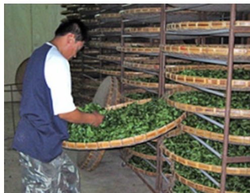
圖表 15 茶葉製作流程-靜置與攪拌。資料來源：本研究
