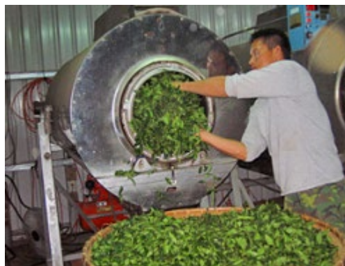
圖表 17 茶葉製作流程-大浪與推菁。資料來源：本研究
