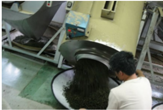
圖表 19 茶葉製作流程-乾燥、烘存。資料來源：本研究
