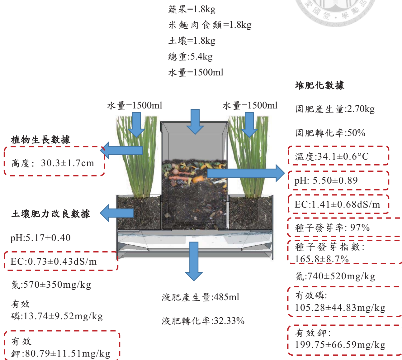
圖 4-14 生廚餘加熱廚餘質量平衡與實驗數據圖
