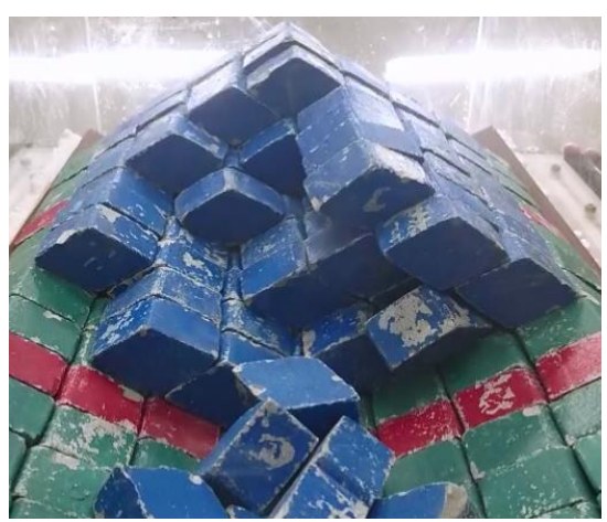
圖 5.3 延續性 80%之物理模型於不同交線傾伏角下之崩落產狀
