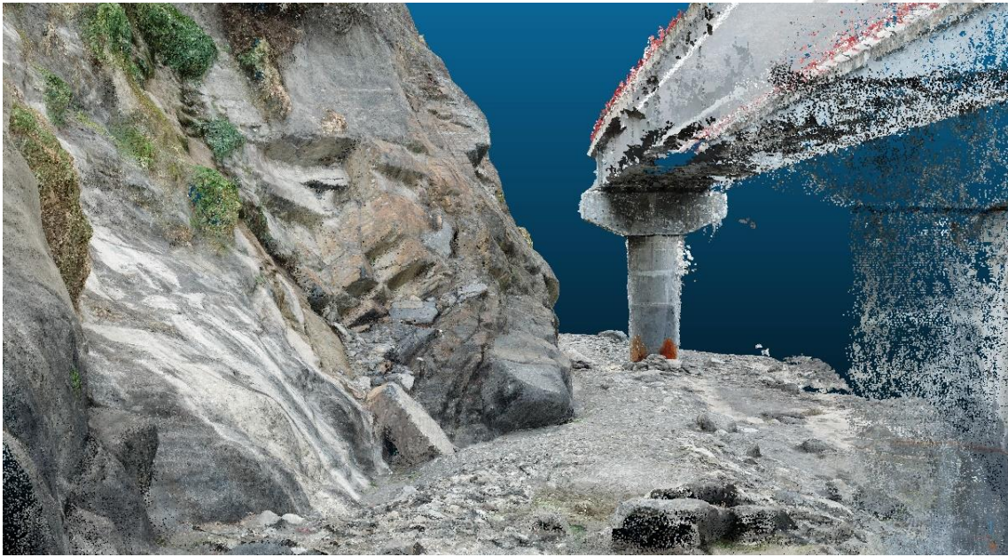
圖 4.11 台 20 線明霸克露橋旁岩石邊坡之點雲模型
