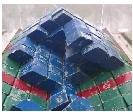
圖 5.3 延續性 80%之物理模型於不同交線傾伏角下之崩落產狀
