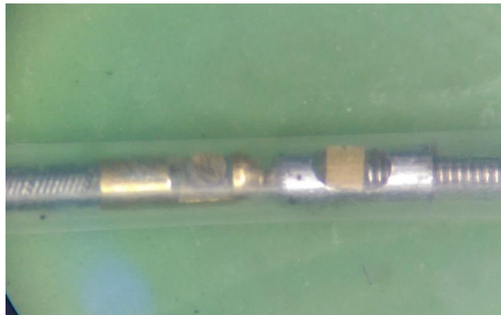
圖 4-15 金屬封裝版本探頭與商用探頭比較
