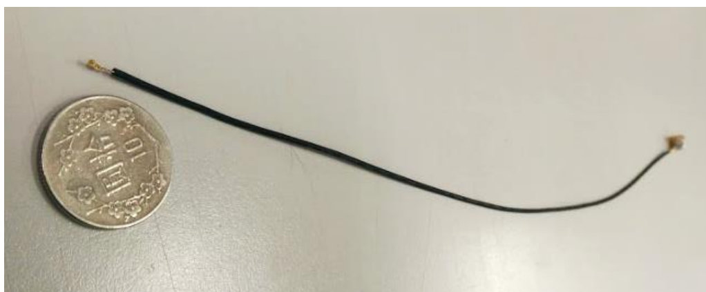
圖 3-9 軟性電路版版本血管內超音波探頭原型
