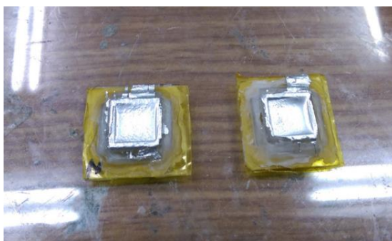
圖 3-4 製作後方匹配層之模具
