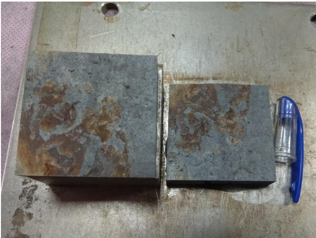
編號 TD12 試體破壞面之銹染情況：
