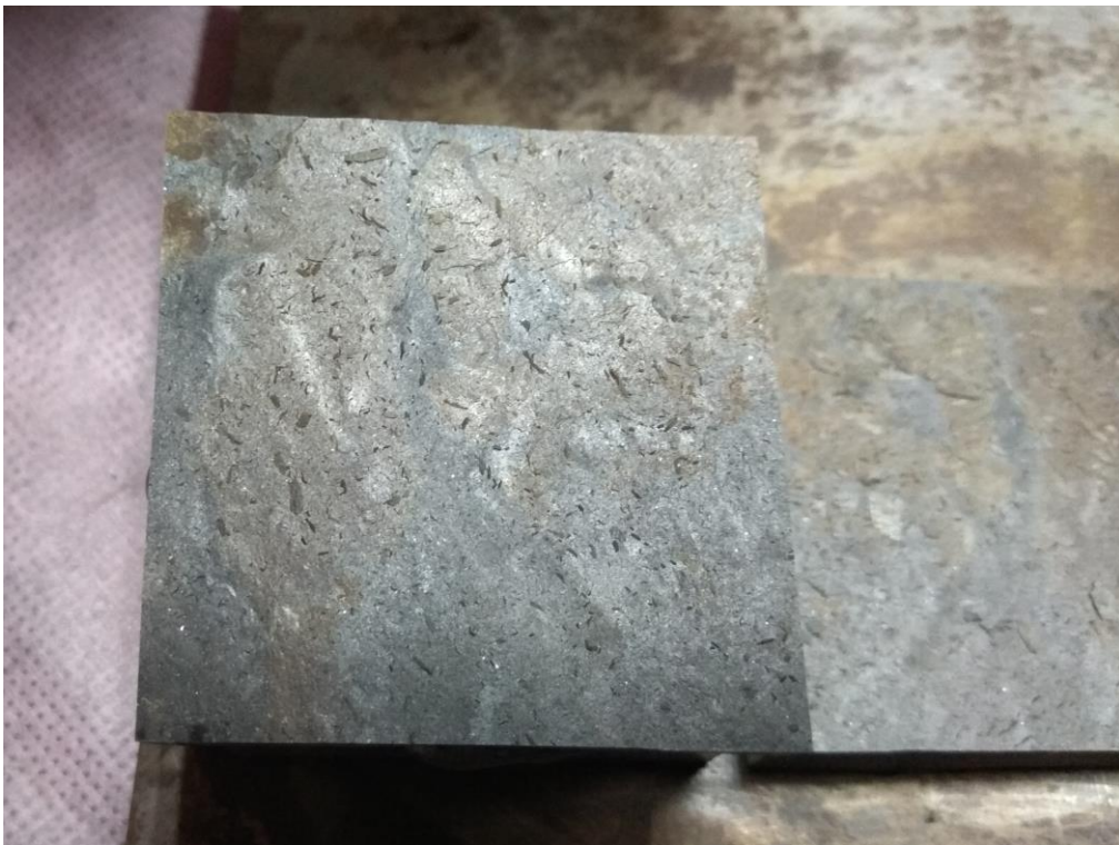
編號 TD10 試體破壞面之銹染情況：
