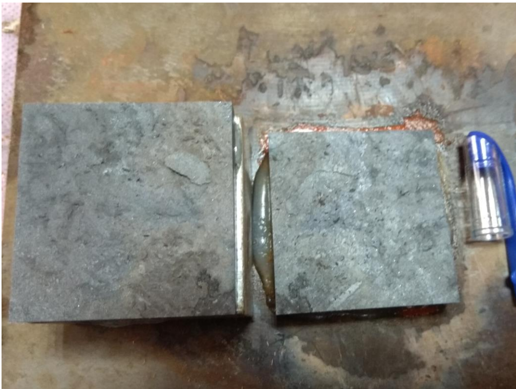
編號 TW8 試體破壞面之銹染情況：
