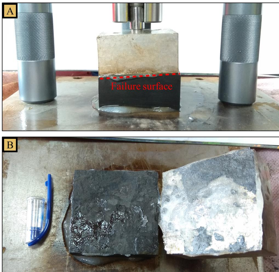
圖 5.4 Mode 3 型態之試體：(A)破壞在黏膠處之試體；(B)介面處之破壞面
