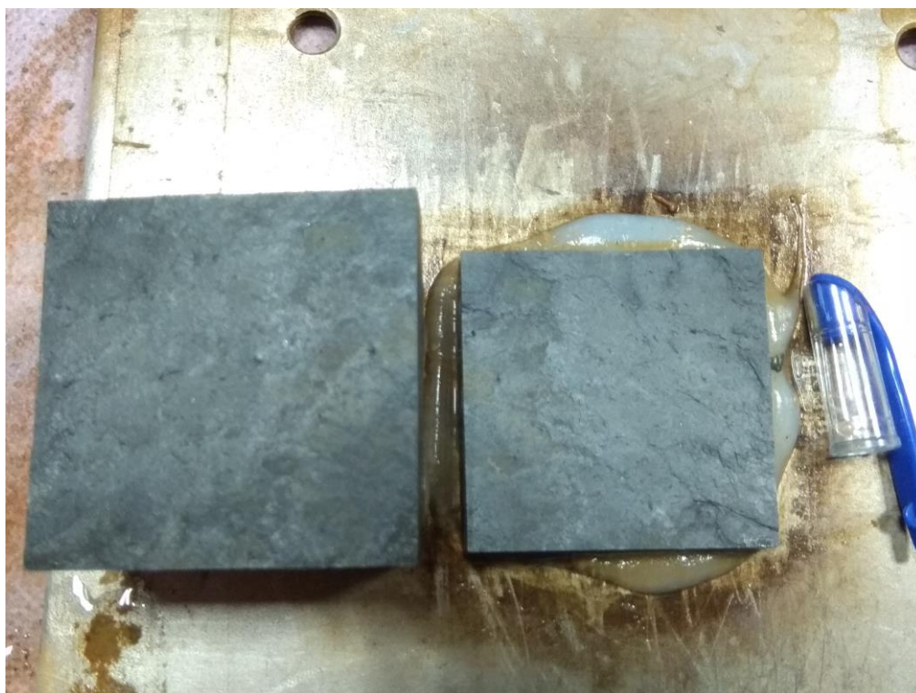
編號 TW13 試體破壞面之銹染情況：
