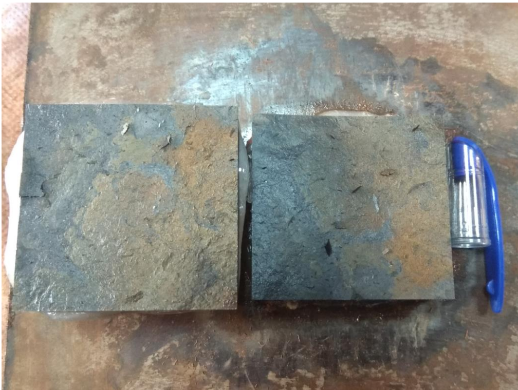
編號 TW12 試體破壞面之銹染情況：
