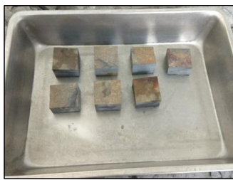
A. 切割岩石製成試體
