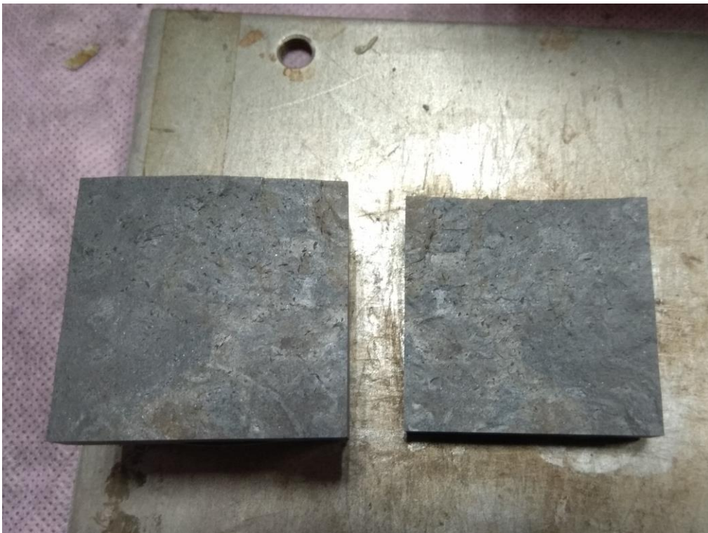
編號 TD9 試體破壞面之銹染情況：
