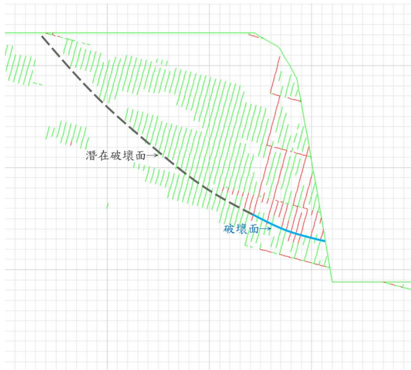
圖 6.18 最終弱面剪動開張情況
