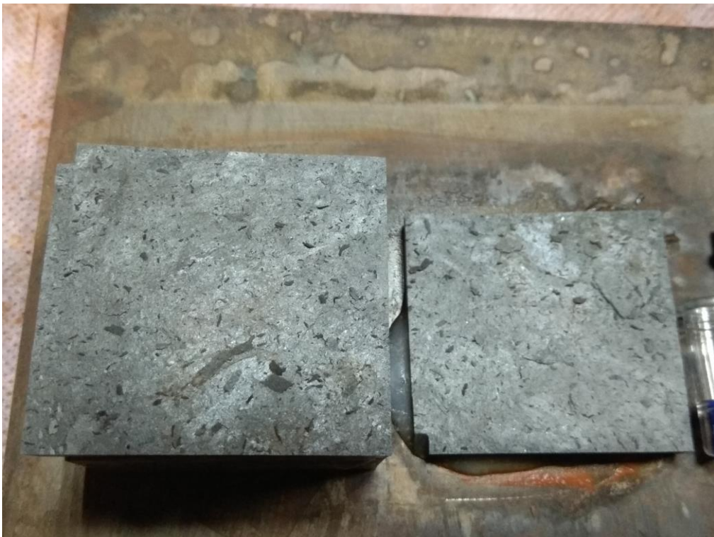
編號 TW9 試體破壞面之銹染情況：
