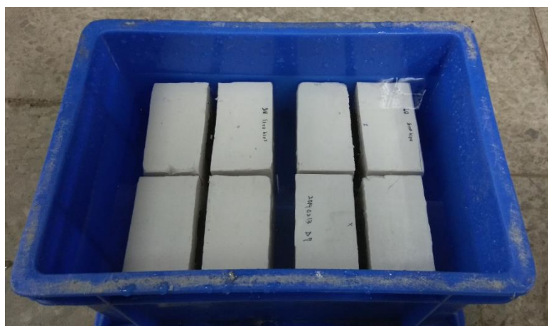
圖 3.13 直接剪力試驗試體浸泡至溼式示意圖
