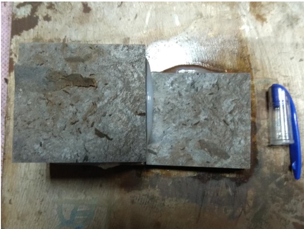
編號 TW4 試體破壞面之銹染情況：
