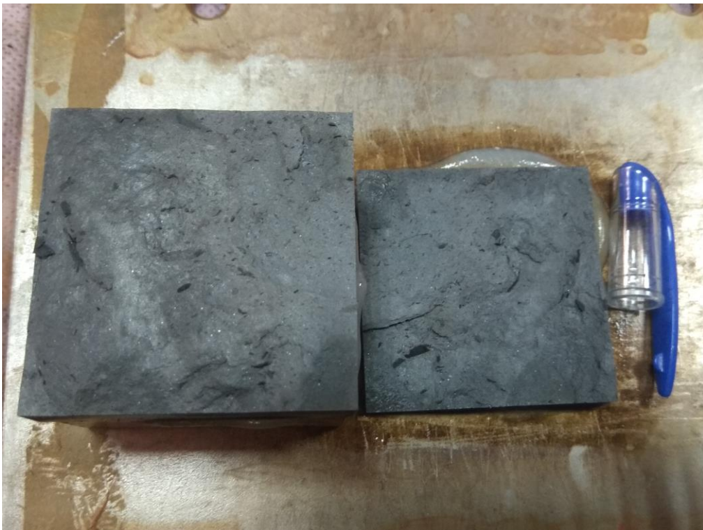
編號 TW11 試體破壞面之銹染情況：
