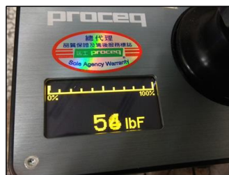
E. 按下開始試驗鍵，儀器拉拔直至試體破壞
