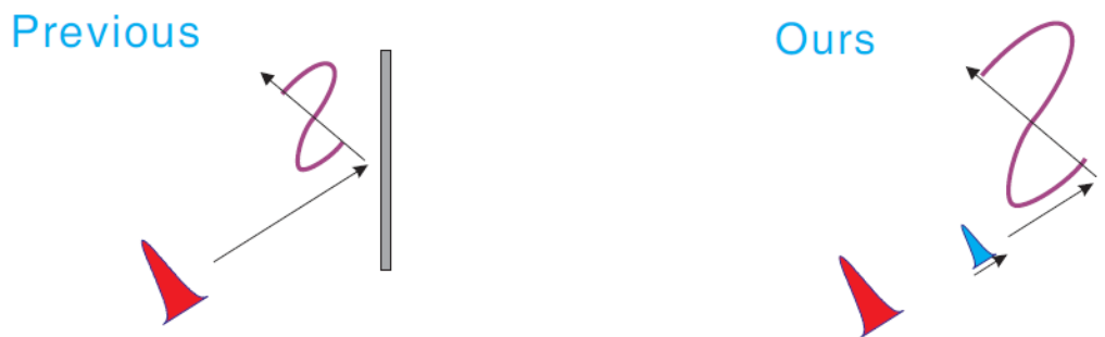
Fig. 2.2.1 本實驗採用一可控制的預脈衝來調變主脈衝打入前的電漿環境
