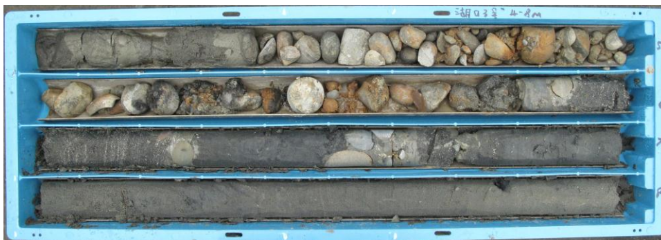
圖 2.7 全新世海相沖積層（湖口 3 號井 4—8 公尺）。以鬆散膠結之砂層夾泥或基質支持礫石為主，富含海相貝殼化石及碳質物。
