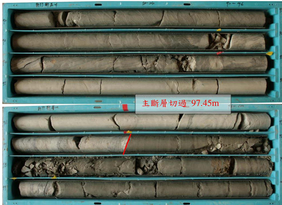
圖 3.20 中正大學新竹四號井第 92—100 公尺。淺於 97.45 公尺的基盤楊梅層皆以高角度傾斜且具有密集剪切帶；深於此深度的楊梅層呈略略水準且無強烈剪切帶，故推測新竹斷層主斷層通過此深度。
