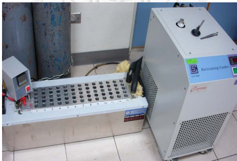
圖 2-1、溫度梯度反應槽。為長方形鋁塊所製成，反應槽兩端分別為加熱 (圖中左側) 與冷卻 (圖中右側) 系統藉此產生溫度梯度，提高對於溫度的解析度。
