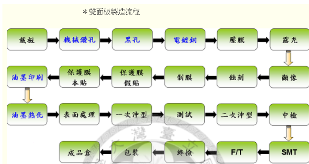
圖 2-3 雙面板製造流程
