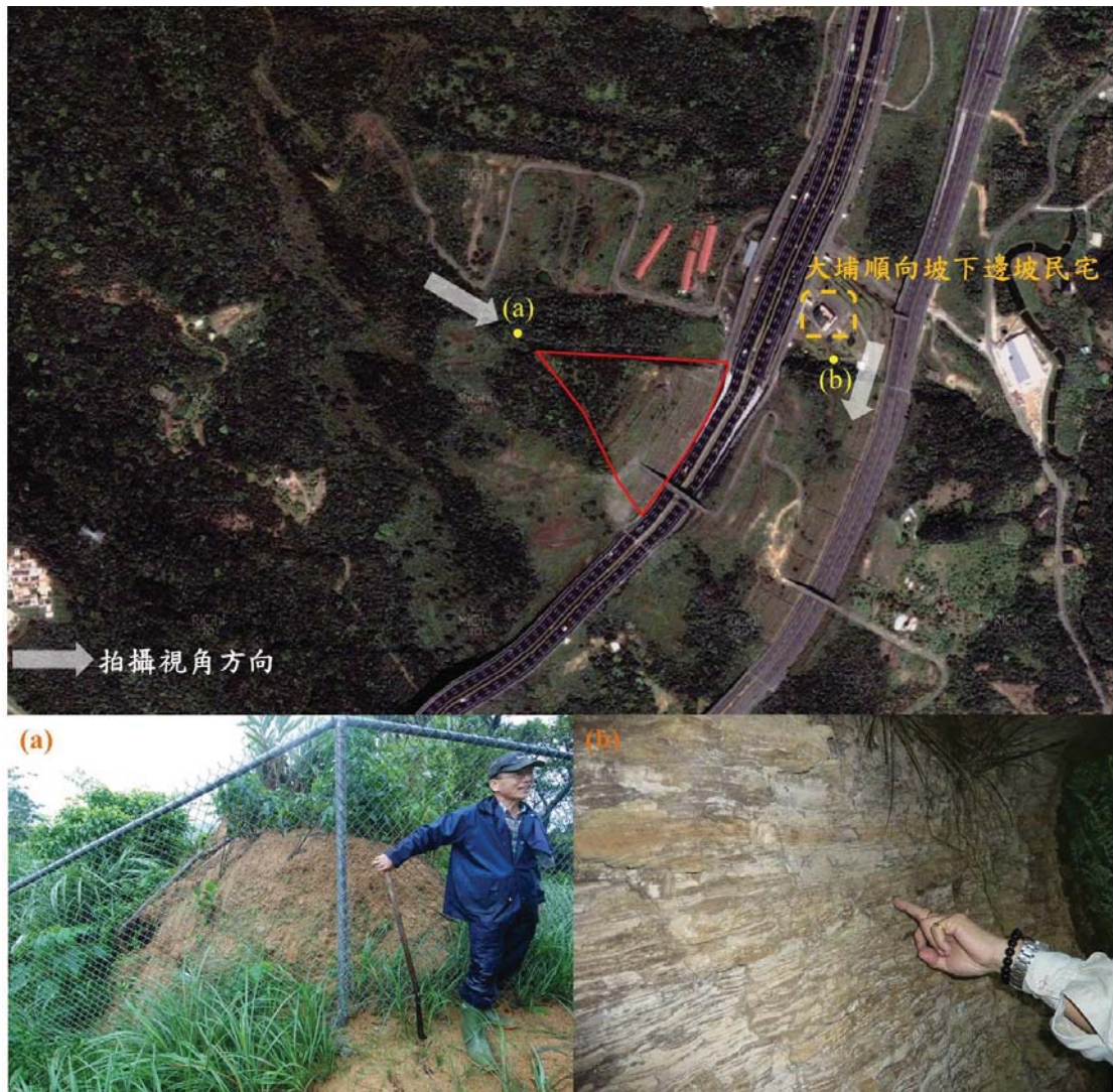
圖 3-1 現地調查-(a)滑動源頭區殘留塊體(b)滑動層於野外露頭之產狀
