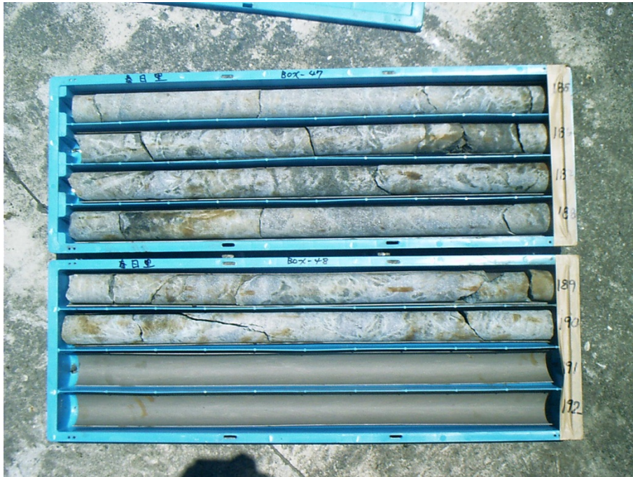
圖 11 SSNB 站岩心照片。設置井下應變儀挑選擺設深度時，會參考岩心記錄決定設置深度，通常在深度兩百公尺附近挑選岩心連續且裂隙少之位置擺放儀器。此處以 SSNB 站岩心記錄為例，本站的井下應變儀設置深度在 185 公尺處。
