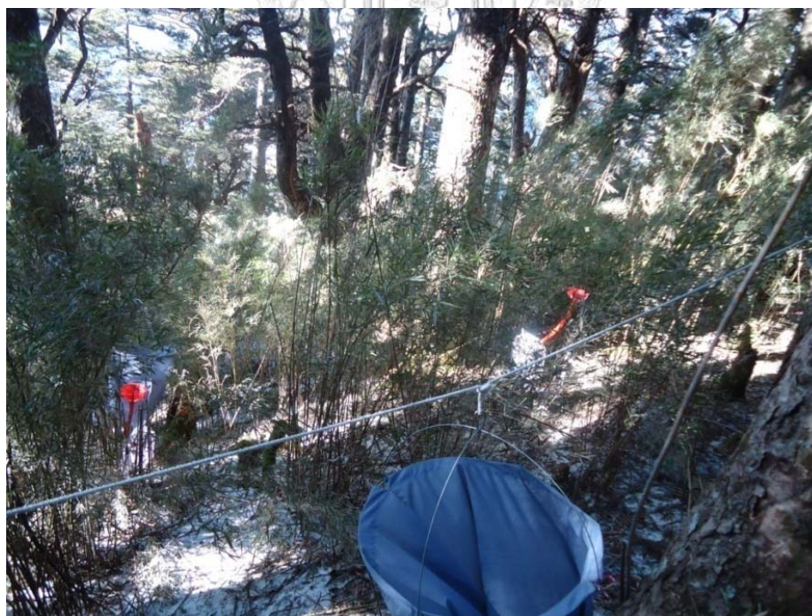
圖 6 冷杉林枯落物網實際架設情形
