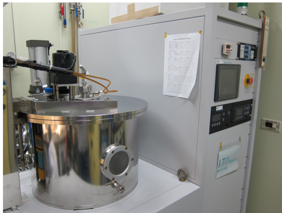
圖 2-8 射頻磁控濺鍍設備
