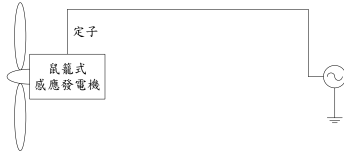
圖 1.3 鼠籠式感應發電機架構圖
