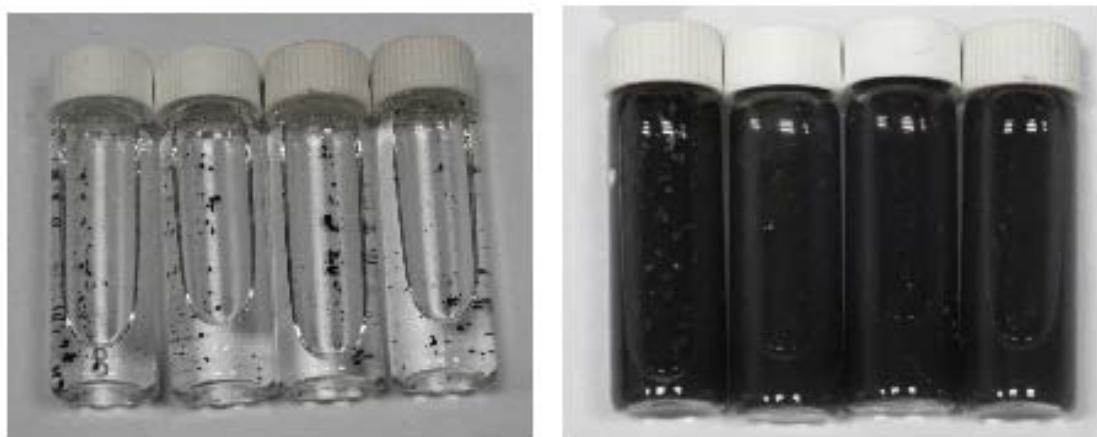
圖 3-2 改質奈米碳管利用超音波震盪前後
