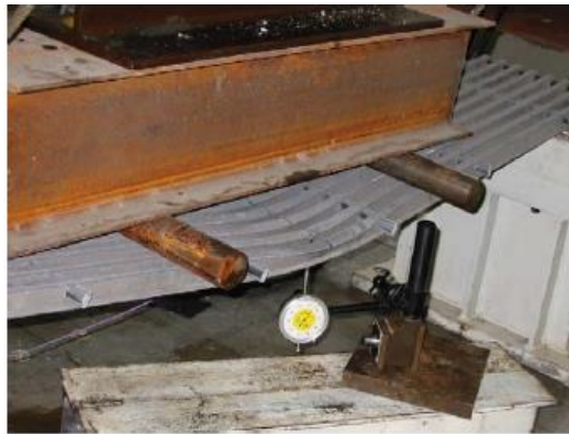
圖 2.5 複合材料格柵板壓力側之主桿產生局部挫屈破壞 (Biddah, 2005)
