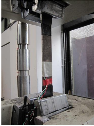
(a) 鋼格柵板主桿拉伸試驗 (試驗前) (b) 鋼格柵板主桿拉伸試驗 (破壞後)
