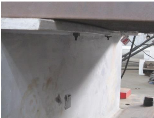
(c) 左、右側複材梁上翼板內側都發生扭轉顯著現象 (300 kN)
