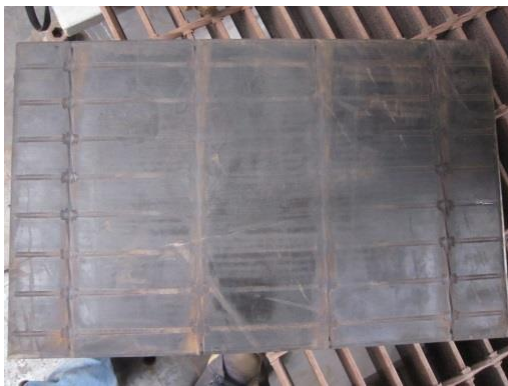
(e) 橡膠墊受 SG2 擠壓痕跡 (試驗後)
