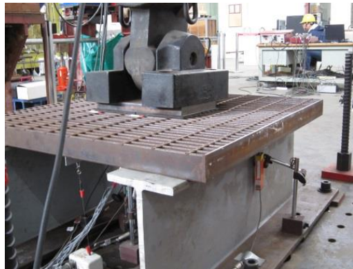
(c) SG1 試體中央沉陷不平均 (264 kN)
