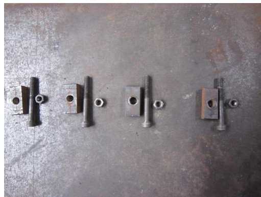
(f) 接合配件完好無損
