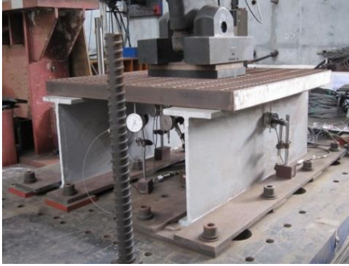
(a) 複合材料梁固定於強力地板
