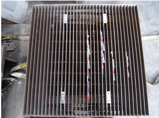
(a) 焊接鋼板於鋼格柵板
