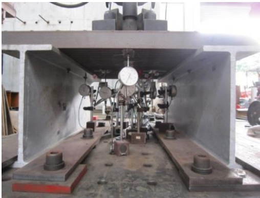
(a) 鋼橋面格柵板位移計架設狀況
