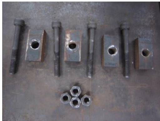
(e) 螺栓無產生任何損傷 (264 kN)
