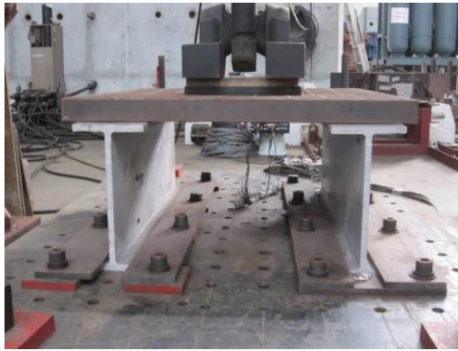
(a) 將 SG2 底下所有位移計移除 (300 kN)
