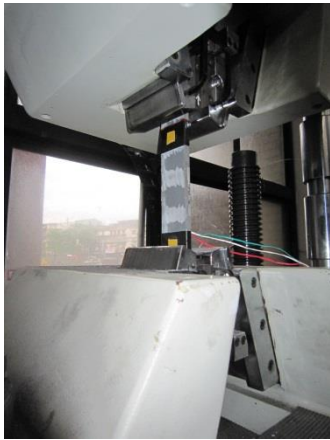
(a) GFRP 格柵板主桿拉伸試驗 (試驗前) (b) GFRP 格柵板主桿拉伸試驗 (破壞後)
