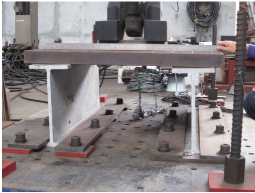
(c) 變形只集中於力量加載處附近 (345 kN)
