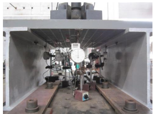
(b) 玻纖橋面格柵板位移計架設狀況
