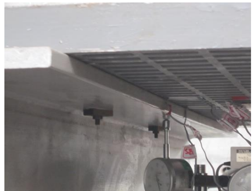
(c) 玻璃纖維橋面格柵板與複材梁連接狀況
