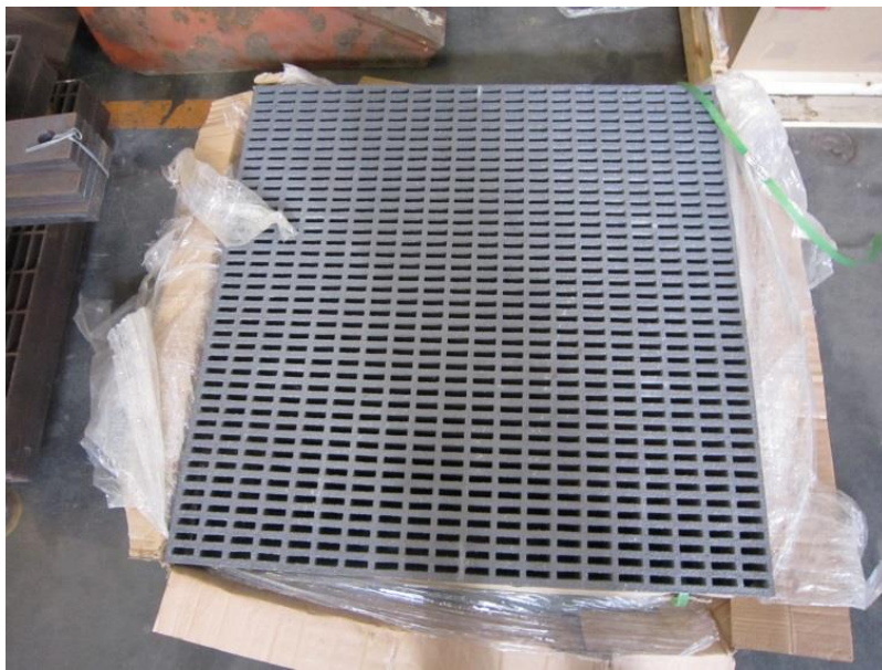
照片 2.2 玻璃纖維橋面格柵板
