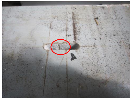
(f) 複材梁開孔處被螺栓擠壓 (264 kN)
