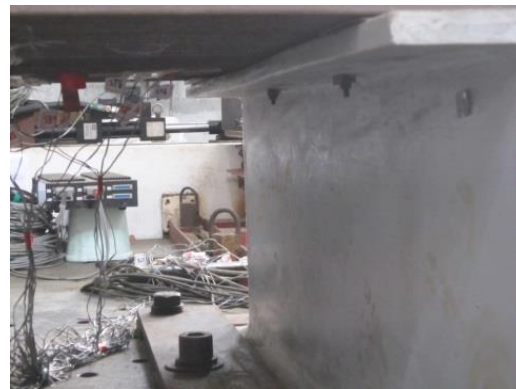
(c) 左、右側複材梁上翼板內側都發生扭轉顯著現象 (300 kN)
