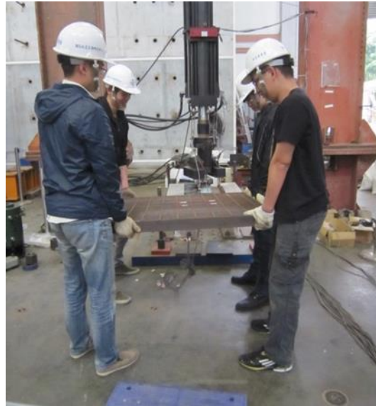
(a) 鋼橋面格柵板
