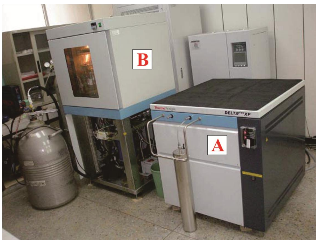
圖 2-13、Kiel III - Delta XP plus IRMS。標記 A 為氣體穩定同位素比值質譜儀 (Delta XP plus Isotope Ratio Mass Spectrometer)；標記 B 為全自動碳酸鹽進樣系統 (Kiel III Carbonate Device)。
