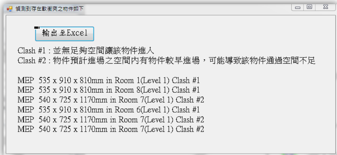
圖 5.3 虛擬案例之軟衝突偵測結果
