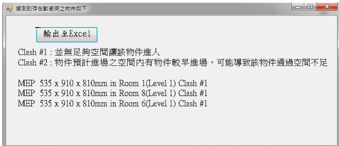
圖 5.5 修正時程資訊後之虛擬案例之軟衝突偵測結果
