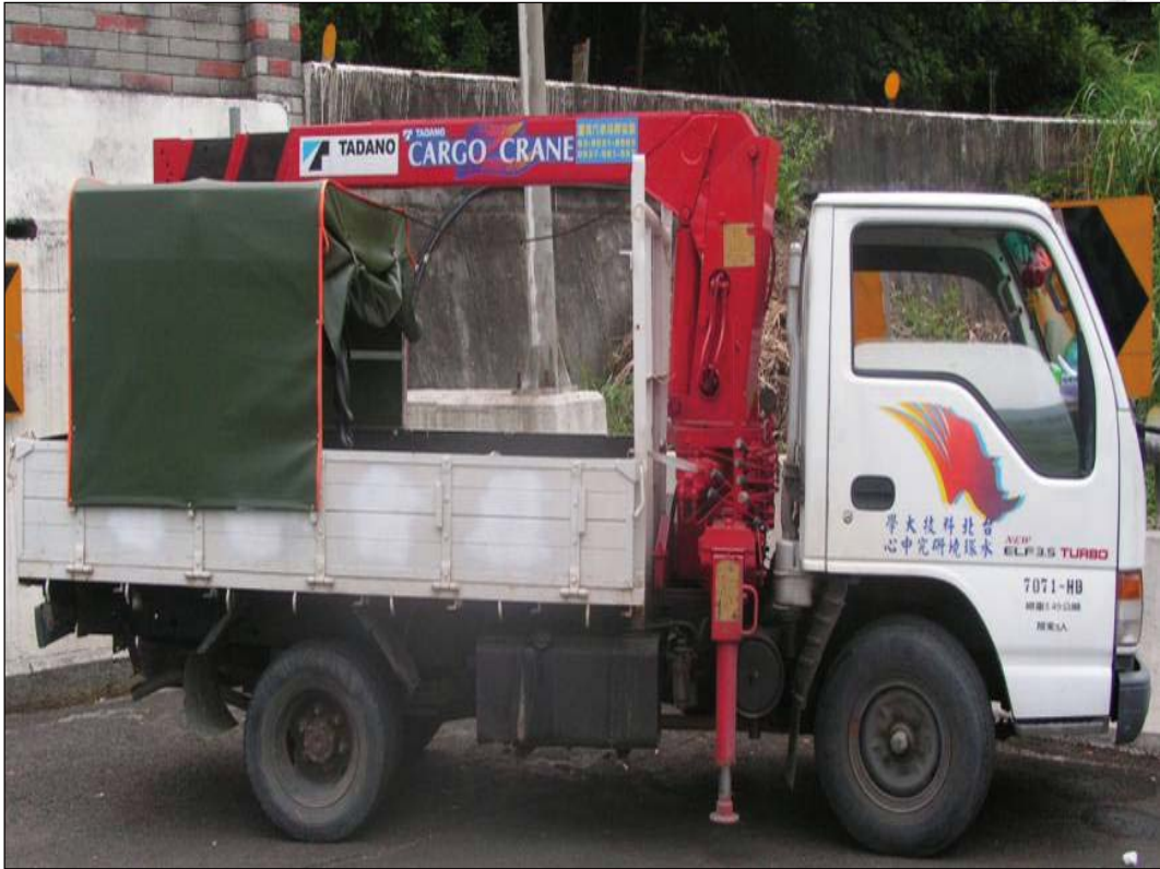
圖 3-2 高流量時期採樣使用之貨車與懸吊設備
