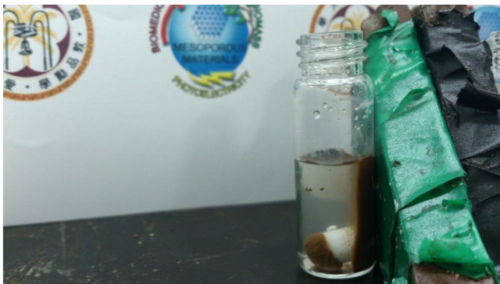
圖 3.2 利用磁鐵分離磁性催化劑以及溶液
