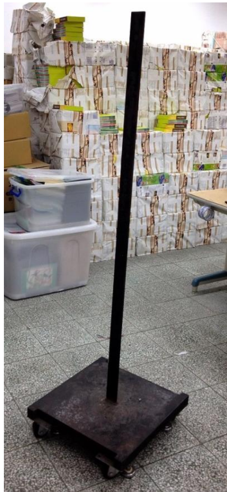
圖 3.3 直立式懸臂鋼樑實際結構圖
