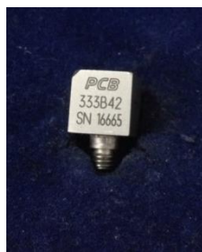
圖 3.8 量測之加速規
