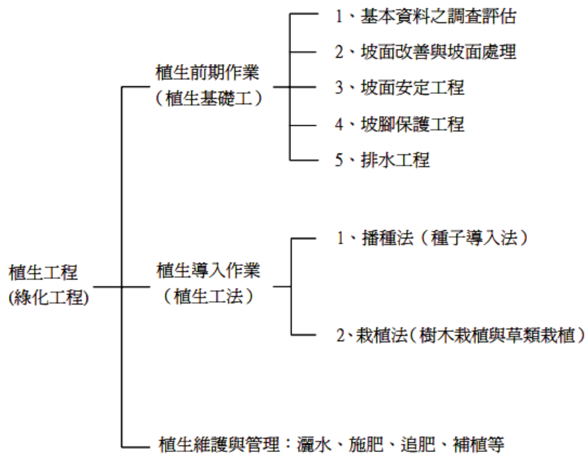
圖3-3、植生工程(綠化工程)之施工三階段(林信輝，2012)
