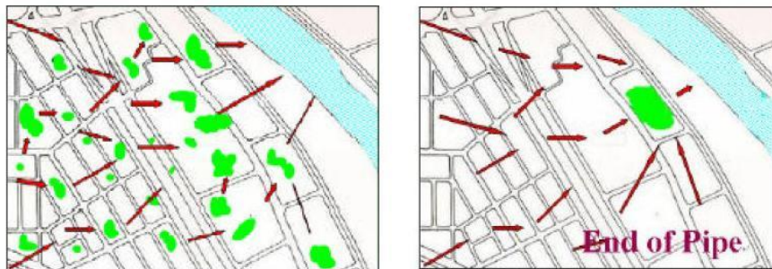
圖 2-2-1 暴雨管理手法（左為小型分散式、右為大型集中式）
