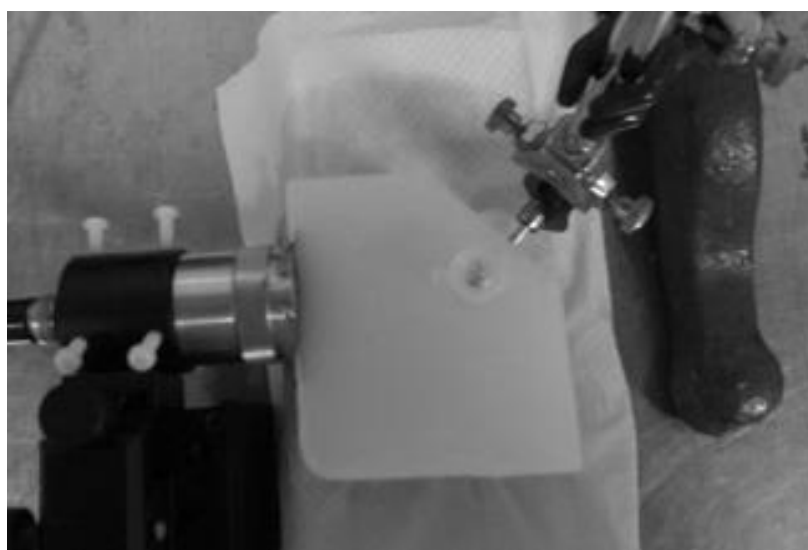
圖 12：此為比較實驗架構之實景，為了降低雷射在仿體中的衰減，因此將其位置調整到仿體右上方。
