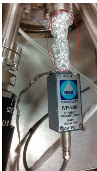
圖 1.7 隔絕外來雜訊的屏蔽。使用鋁箔(圈起之處)進行前置放大器(圖中的 IVP-200)訊號接頭的屏蔽。
