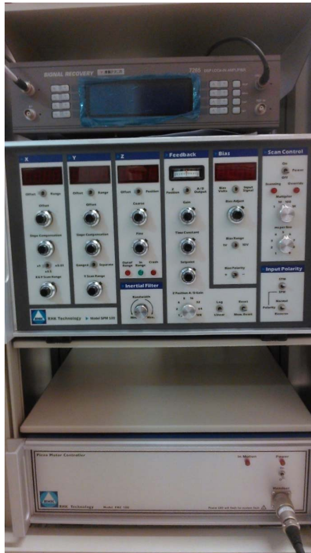
圖 2.8 STM 控制器和鎖相放大器。由上而下依序是鎖相放大器、電子系統控制器及壓電馬達控制器。
