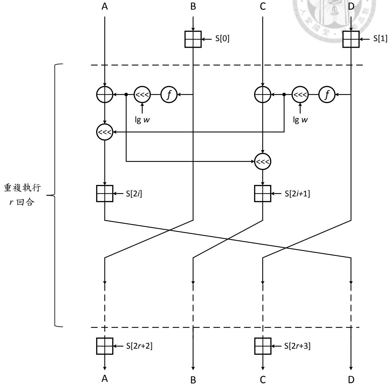
【圖 3-3-1】 RC6 加密流程示意圖
