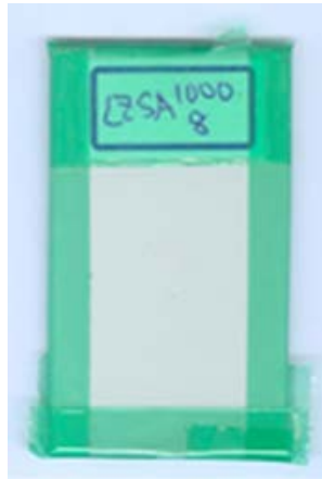
圖 3-17 防蝕膠帶貼附於準備鹽霧試驗之試片
