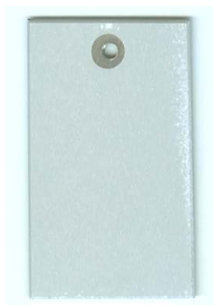
圖 1 10 g/L 矽酸鈉中添加 5 g/L 鋁酸鈉所製作的 LZ91 微弧氧化試片
