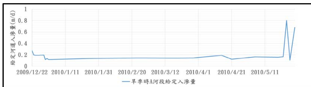
圖 4-30 旱季時 A 河段之給定河道入滲強度
