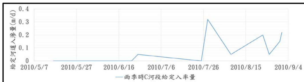
圖 4-33 雨季時 C 河段之給定河道入滲強度
