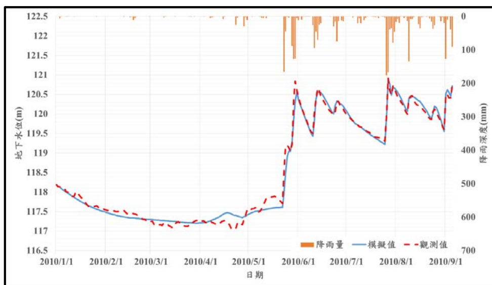
圖 4-36 觀測井 C 之暫態模擬水位與觀測水位比較圖
