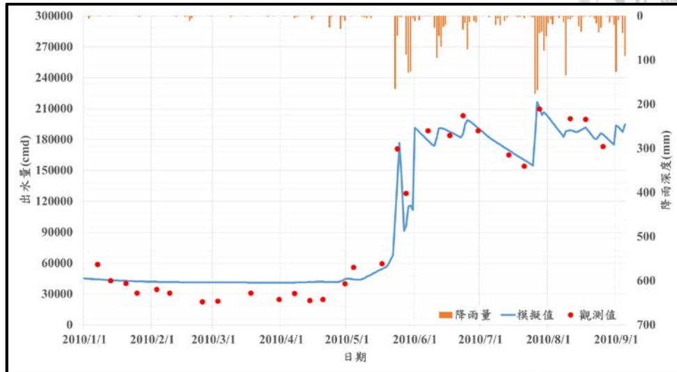
圖 4-42 集水廊道之暫態模擬集水量與觀測集水量之比較圖
