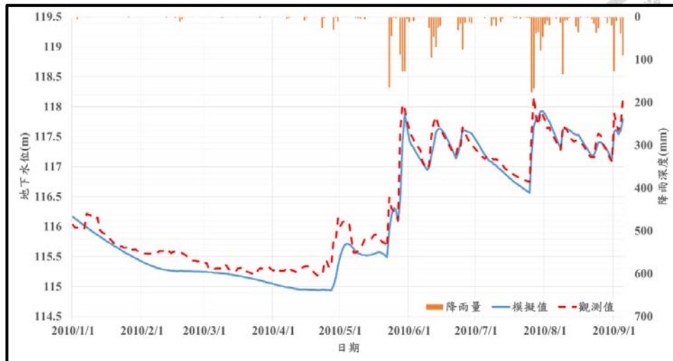
圖 4-38 觀測井 D 之暫態模擬水位與觀測水位比較圖
