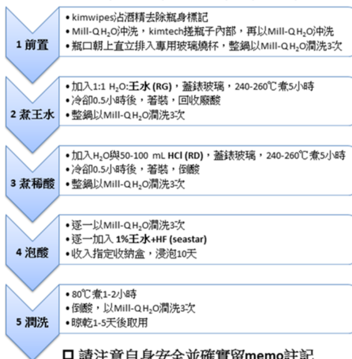
圖 3.4 鐵氟龍材質實驗器皿清洗步驟
