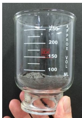
圖 4.2.3-1 玻璃過濾器底部為 60 mesh 篩網，用來盛放或過濾污染土壤。
