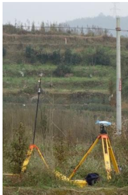
圖 3.3.4、地面控制點基準站，左側為無線電波發射器將訊號傳遞給手部控制器。右側為碟形天線，主要功能為接收 GPS 訊號。
