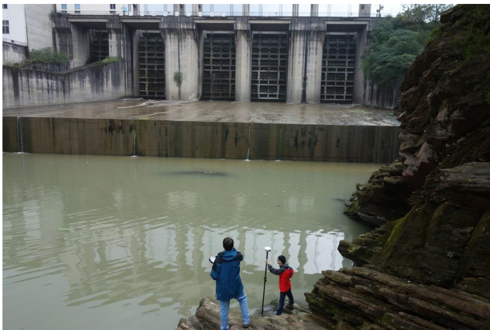
圖 3.3.9、河道高程量測實際圖，此圖地點為天全縣河道發電站下游處量測點。
