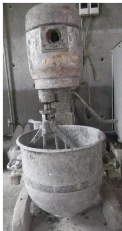
照片 3-1 中型單軸拌和試驗機
