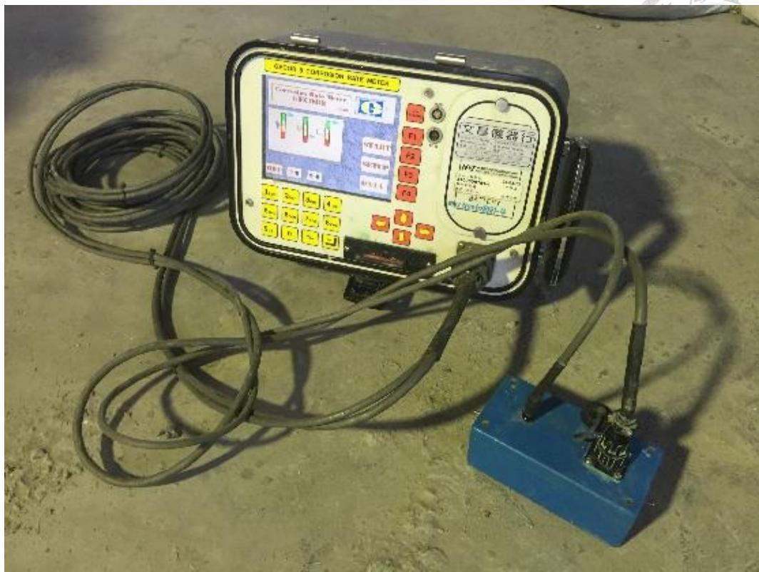
照片 3-9 試驗假試體校正
