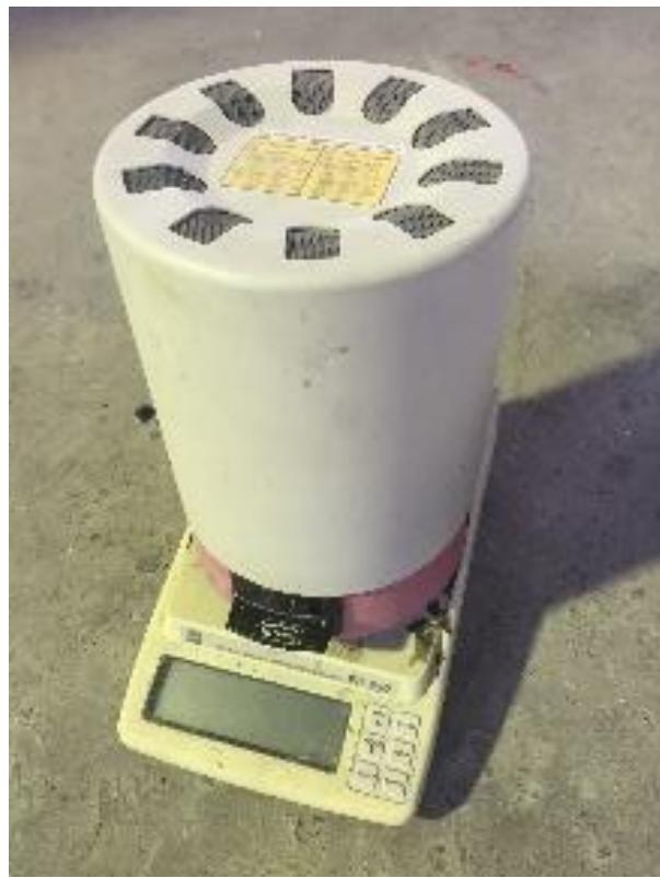
照片 3-8 紅外線含水量測定儀
