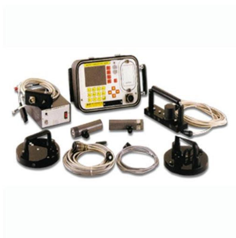
照片 3-5 Gecor 8 鋼筋腐蝕速率測定儀
