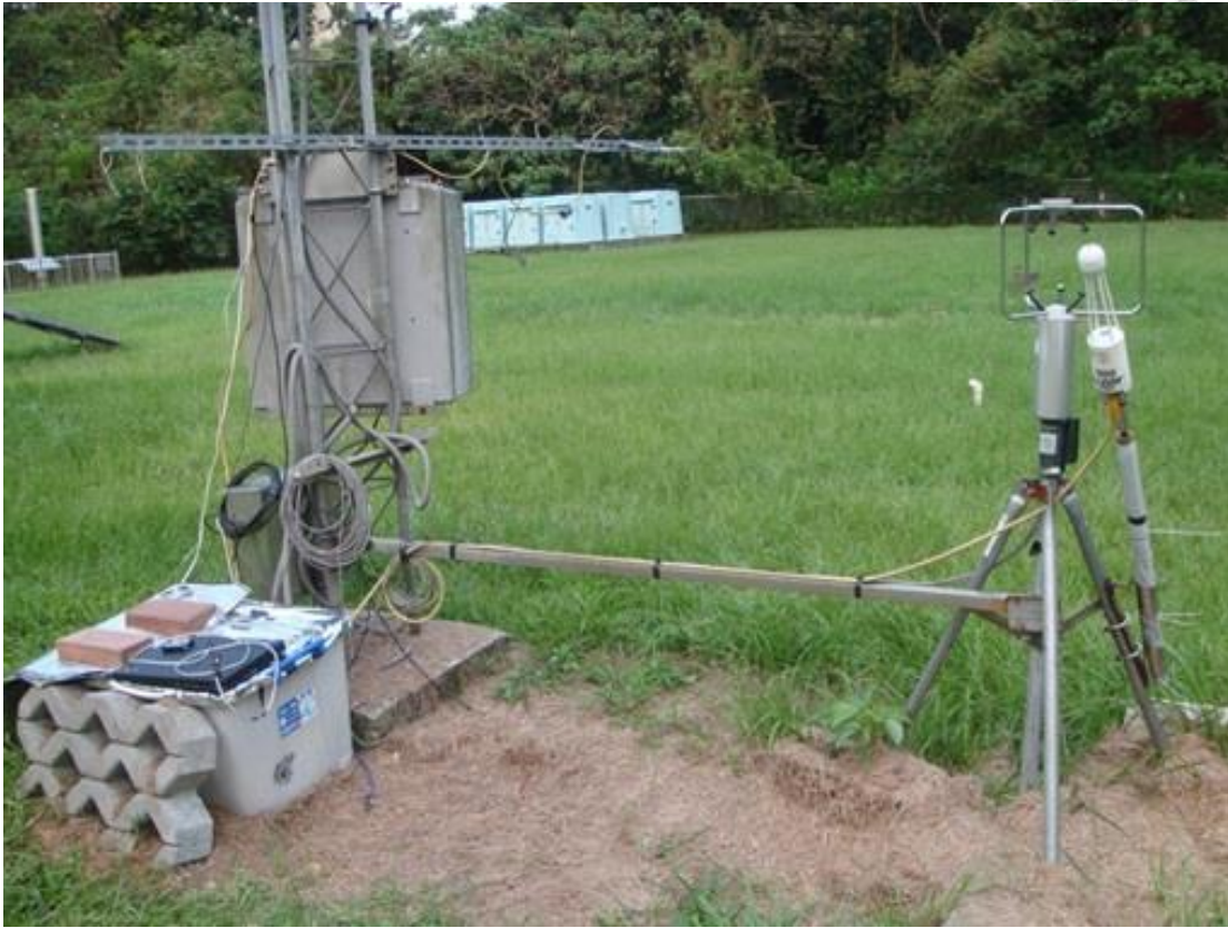
圖 5 台灣大學大氣系觀測坪渦流相關系統及氣象站架設情形。
