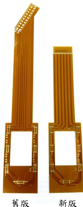
圖 2-27 近接感測器軟式電路板舊版與新版實體圖比較
