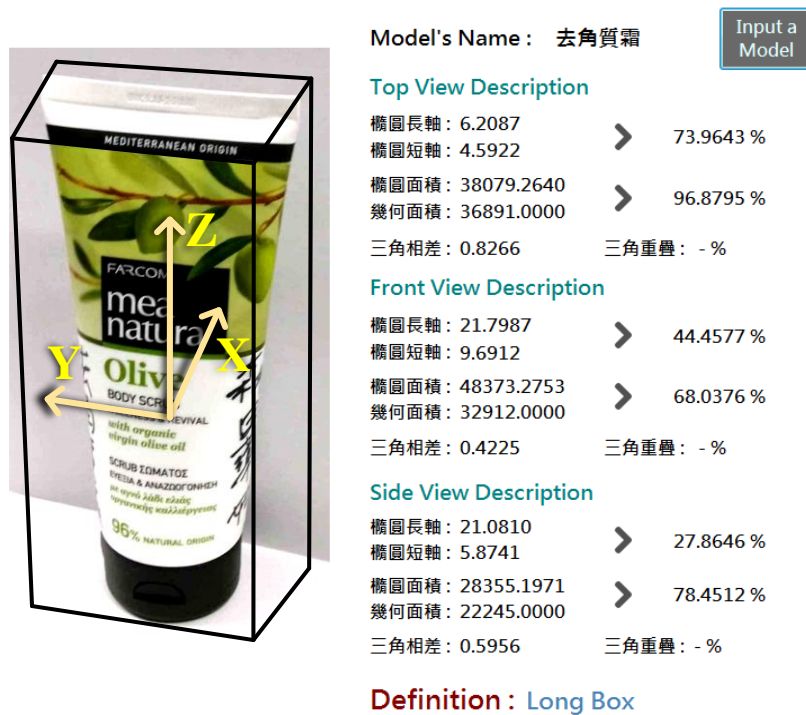
圖 3-11 去角質霜實體圖與各投影面分析結果
