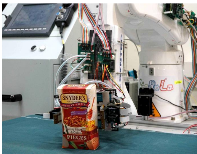
圖 4-29 直立蝴蝶餅乾(長方體)的夾取姿態計算實驗結果
