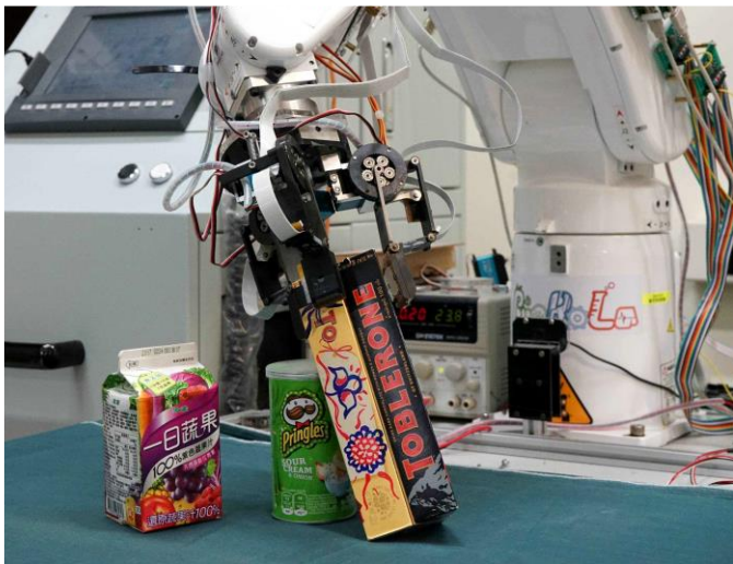
圖 4-36 目標品客波卡(圓柱)被倚靠的夾取姿態計算實驗結果
