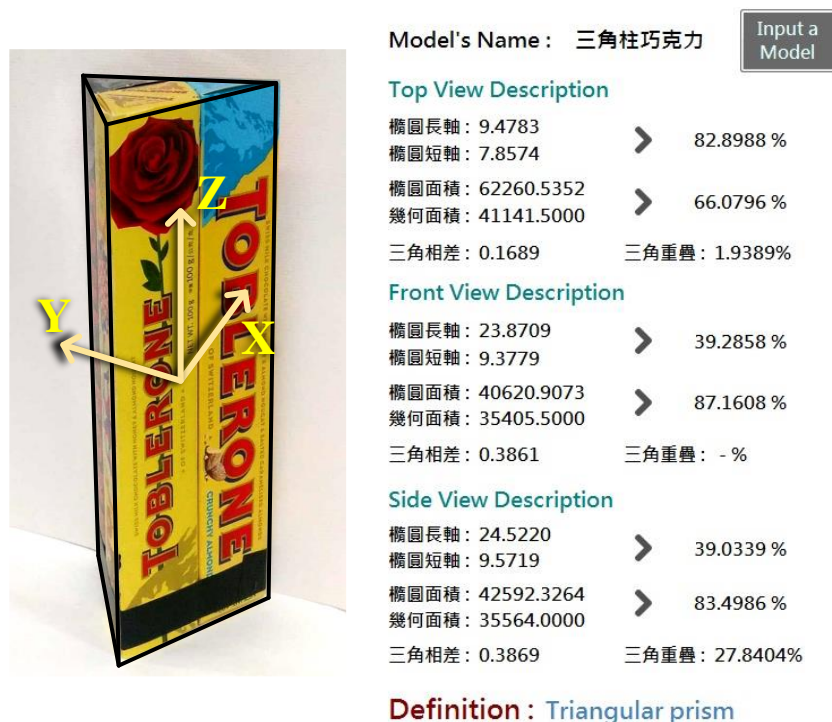
圖 3-13 三角巧克力實體圖與各投影面分析結果
