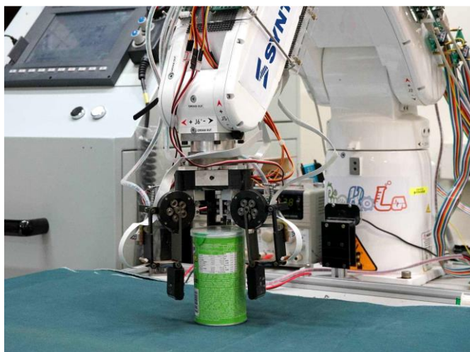
圖 4-8 站立品客波卡(圓柱)的夾取姿態計算實驗結果
