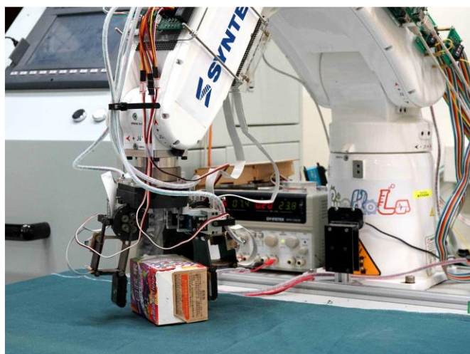
圖 4-20 一日蔬果(長方體)第一種情形的夾取姿態計算實驗結果
