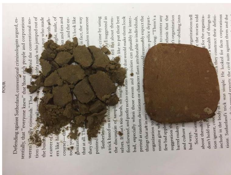
圖 4. 陰乾後的試片測試，圖左為粉砂土，圖右添加 50% 紅土
