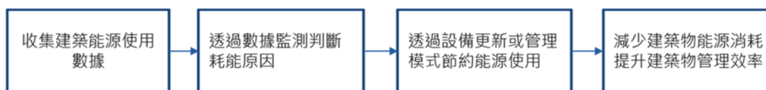
圖 1 目前建築能源管理系統之運作概念
