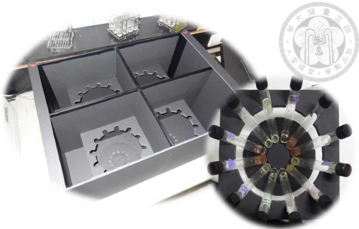
附圖 1、光照培養箱之設計。(左) 可供四種光照條件的 chamber; (右) 每個 chamber 可以放置 12 管樣品，光源從圓心正上方照射。整個裝置以棉線固定於培養箱中。
