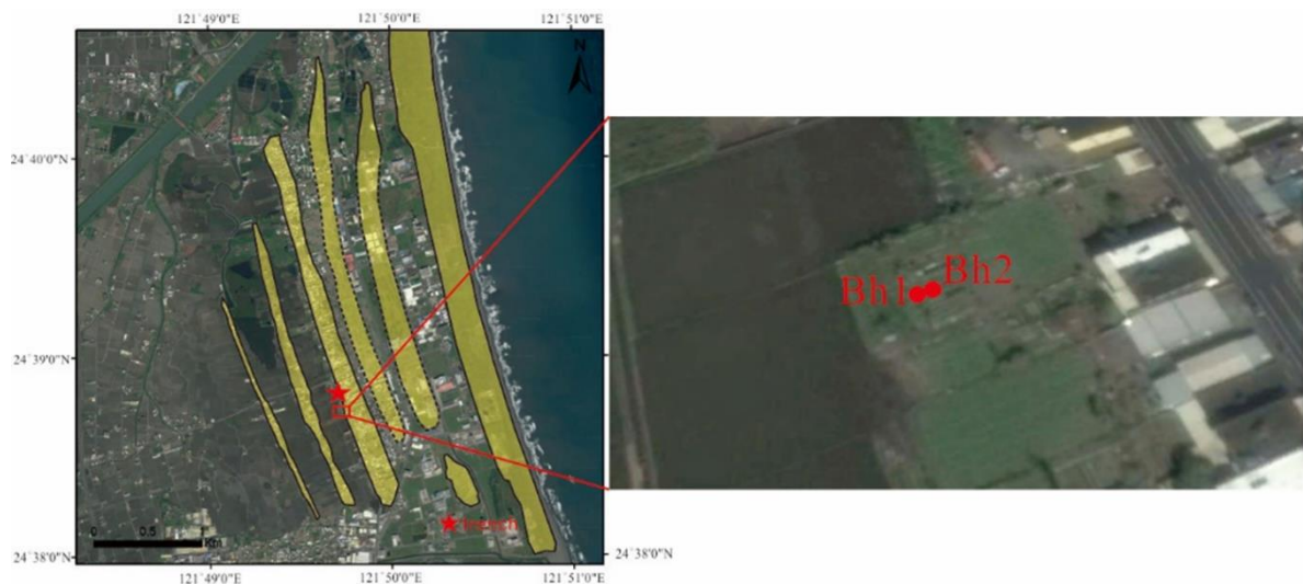
圖 4-12、宜蘭平原南部龍德地區所鑽取之沉積物岩芯詳細位置。Bh1 位於較西側，Bh1 與 Bh2 距離水平約為 7 公尺。高度部分，Bh2 之地表位置較 Bh1 之地表位置高約 5.6 公分。
