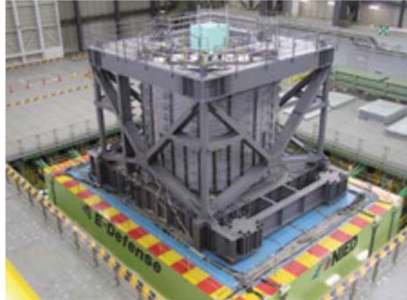
圖 2.9 土壤－群樁基礎－上部結構互制試驗照片[16]
