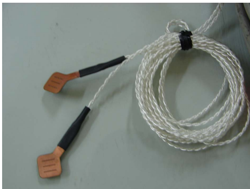
圖 3.11 微型壓力計 (Tactile sensor)
