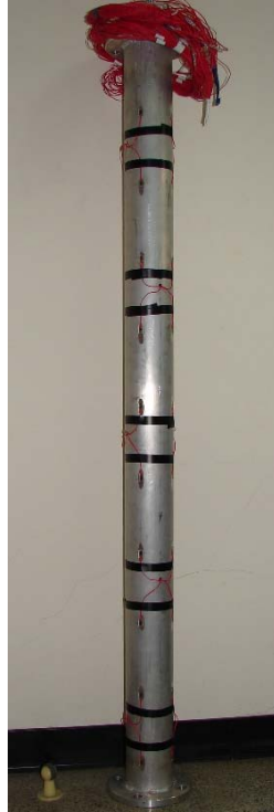
圖 3.13 黏貼應變計之模型鋁樁照片
