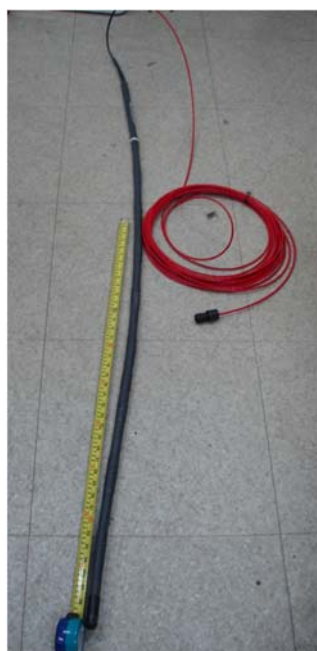
圖 3.12 陣列式位移計 (ShapeAccelArray)
