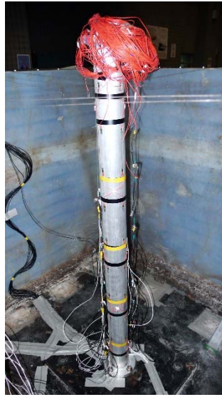
圖 3.23 傾斜地盤試驗模型樁量測儀器安裝情況
