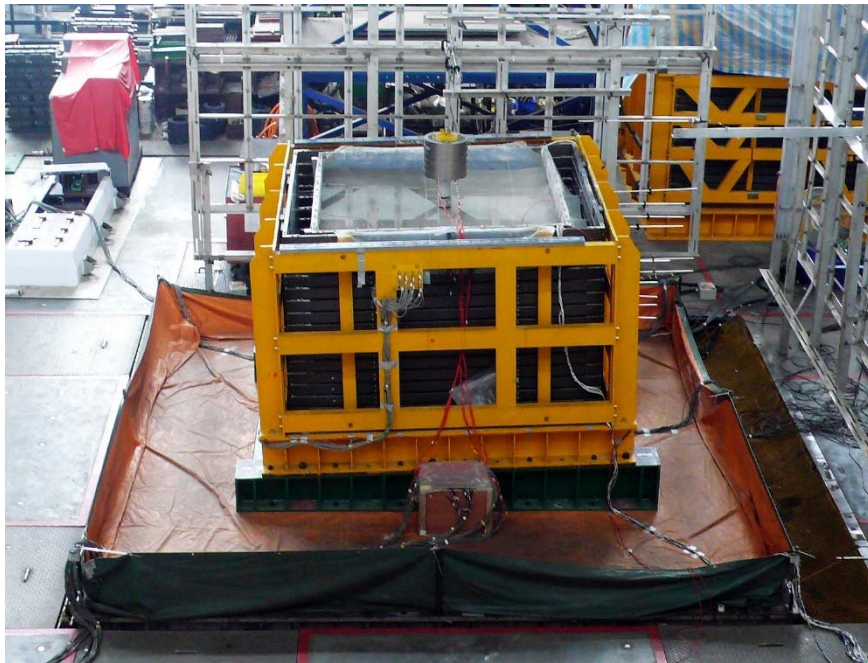
圖 3.24 傾斜地盤模型樁振動台試驗之情形
