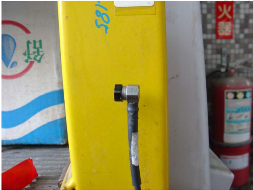
圖 3.7 PCB 微型加速度規
