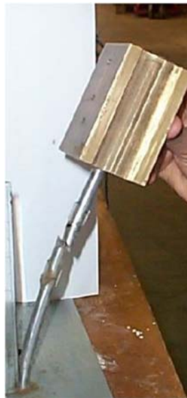
圖 2.5 離心機模型試驗中挫屈破壞情況(Bhattacharya, 2003)[9]
