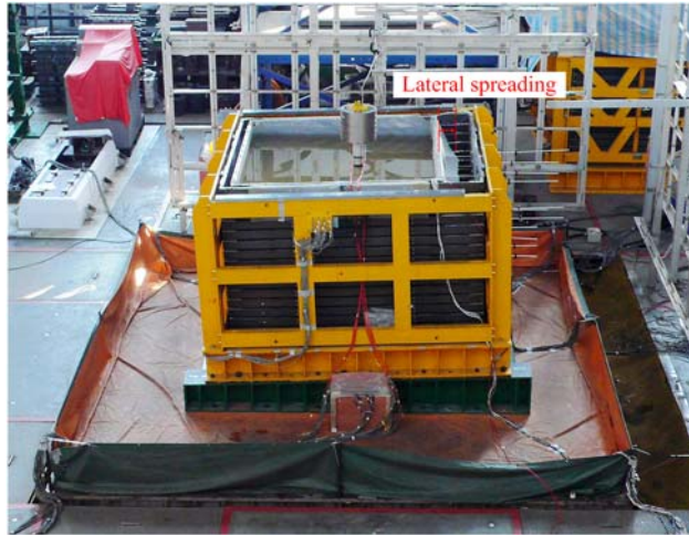
圖 5.4 傾斜地盤試驗中，地盤液化側潰照片
