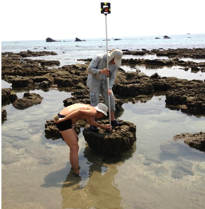
圖 3-4 利用全站儀測量珊瑚微型環礁環狀邊緣高度。 本研究使用全站儀測量選定之珊瑚微型環礁的不同高度環狀邊緣，以了解研究區域內珊瑚微型環礁在記錄最高生存面時的精確度。
