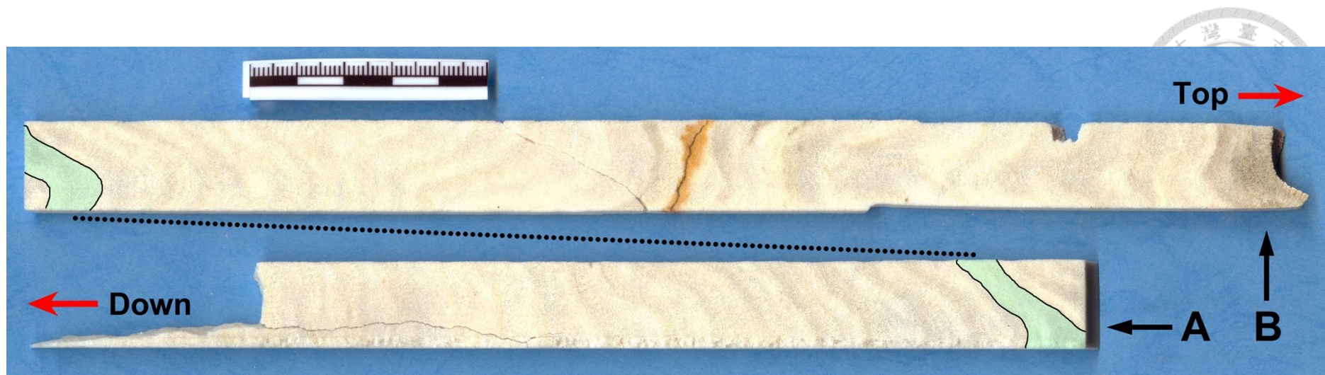
圖 3-9 利用中型鑽石複線切割機沿垂直珊瑚生長紋方向切下薄片。由於受切割機切割長度之限制，必須將珊瑚分為兩段取樣，為了組合兩段薄片的分析結果，切割時選定同一層年生長紋（標示為綠色的層位）在兩段中重複出現以利對比。A 段為珊瑚下部，長約 19 公分，B 段為珊瑚上部，長約 26 公分。
