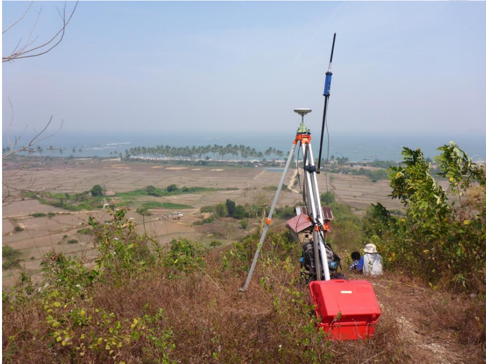
圖 3-5 架設於海階面上的 RTK-GPS 基站。
