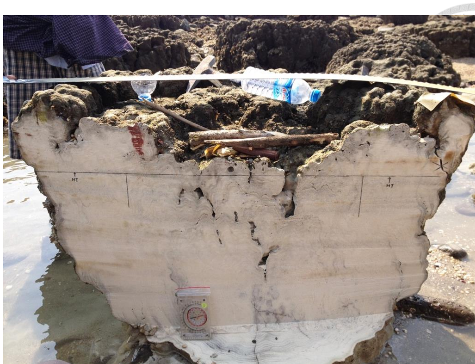
圖 3-8 於珊瑚樣本切面上繪製水平參考線以供影像校正。
