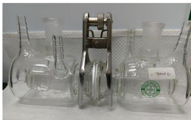
圖 3-1 非均相薄膜反應裝置示意圖及實際照片
