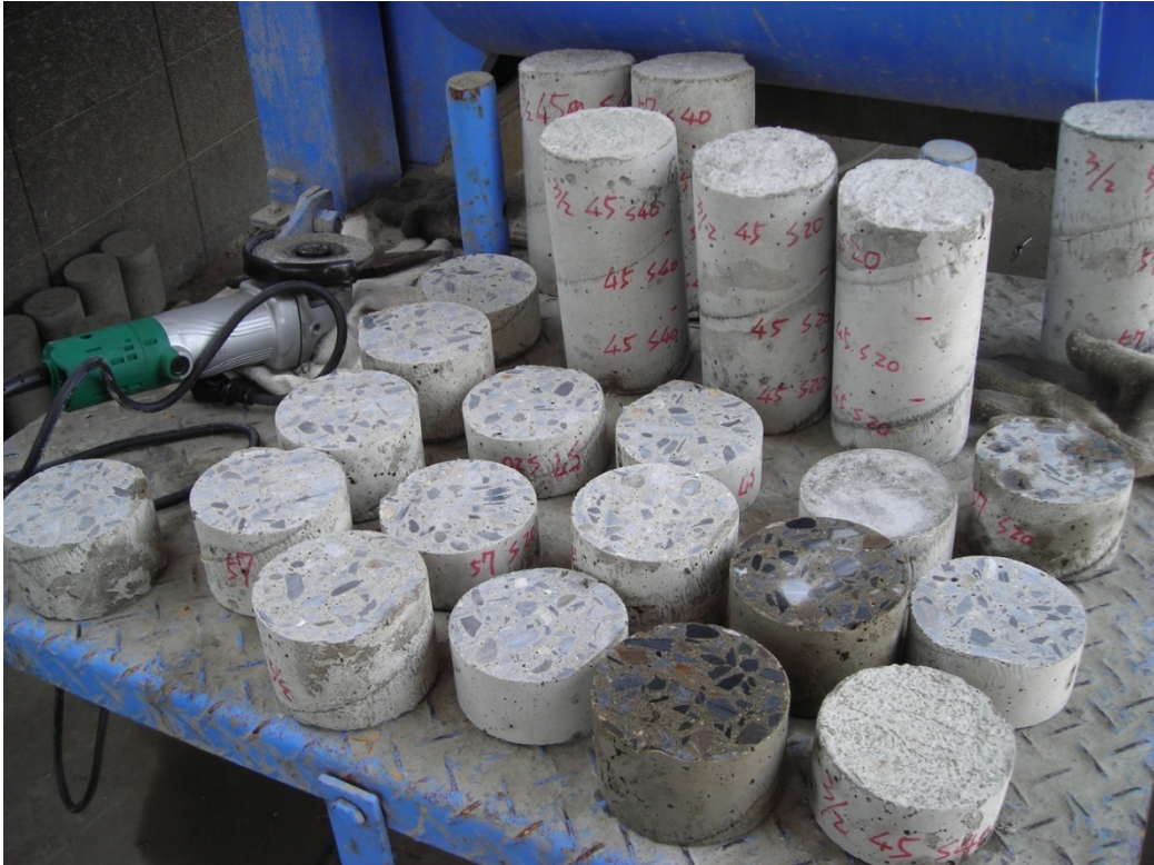
照片 3-11 切割後混凝土試體
