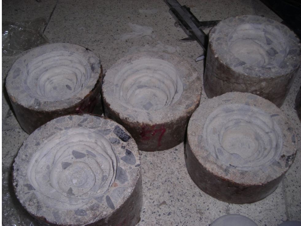
照片 3-15 試驗後之混凝土試體
