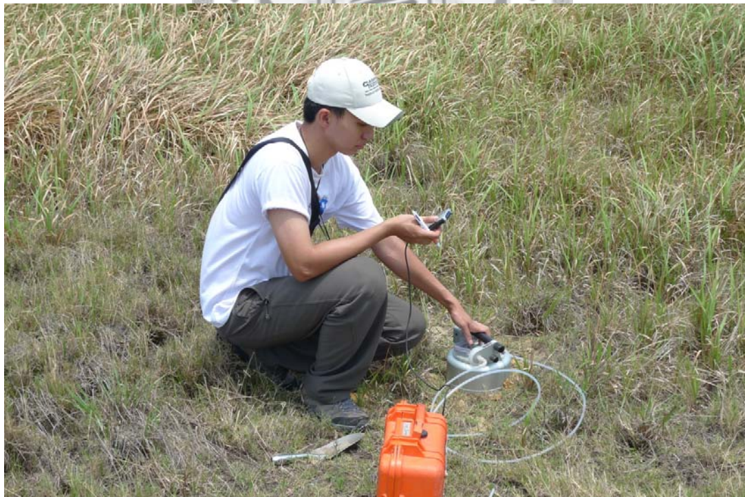
圖 3-4：使用密閉氣罩法量測土壤逸氣通量之工作情形。
