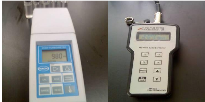
圖 2-4 Hach 2100P 濁度計與 McVan NEP160 手持濁度計 (本研究拍攝)
