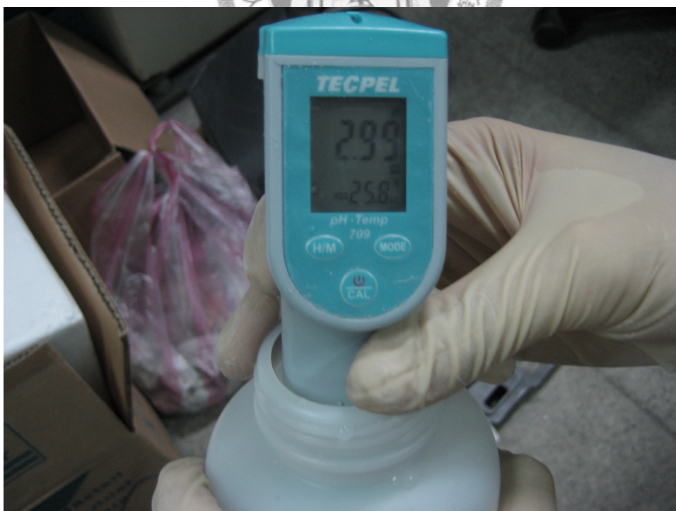
圖 3.4 以 pH 計量測腐蝕液酸鹼度
