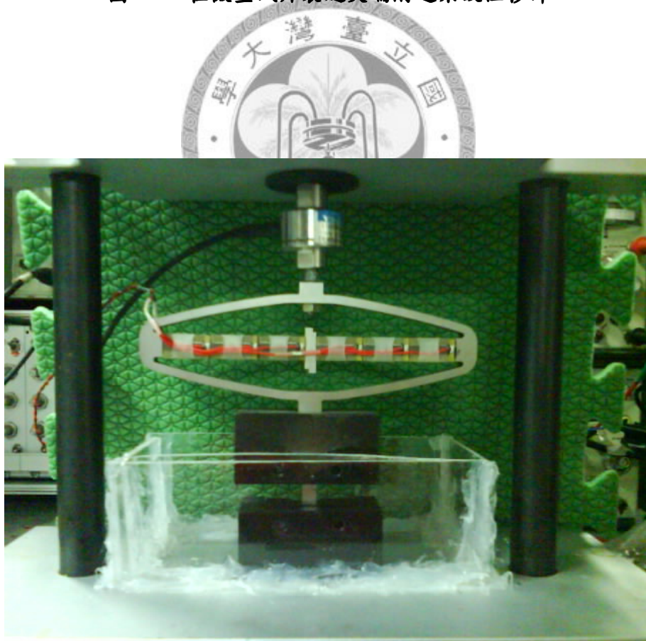
圖 3.23 在微型試片裂縫尖端附近架設位移計
